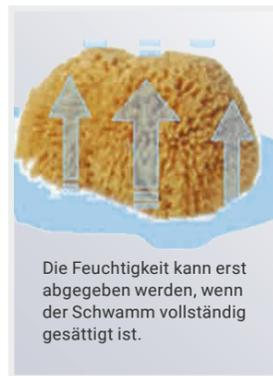
Beispiel für Sättigung der Wärme in der Materie am Beispiel eines Schwammes. Bis der optimale Speicher- Abstrahlungseffekt eintritt kann es länger dauern. Ähnlich verhält es sich mit der Speicherung von Wärme in der Materie (ausgehend von einer korrekten Bauphysik).
